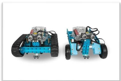
Schicke den mBot Ranger auf Erkundungstour und lasse ihn fahren und verschiedene Aufgaben bewältigen. Mit Hilfe der graphischen Programmieroberfläche kannst du den mBot einfach und unkompliziert programmieren und die Einsatzgebiete mithilfe der Sensoren erweitern. Per Bluetooth kannst du dem mBot deine Befehle geben und ihn in Bewegung setzen. An dem Tag hast du genug Zeit, dir auch eigene Aufgaben auszudenken.
